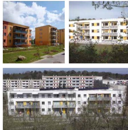
Eine moderne, zukunftsweisende Architektur, die durch Teilrückbau und Umbau der vorhandenen Bausubstanz erzielt werden kann, bedingt in gleicher Weise die Umsetzung energiesparender Maßnahmen. So werden alle Fassaden, Dächer und Kellerdecken mit starken Dämmschichten aus Mineralwolle versehen. Isolierverglaste Fenster und wärmegeämmte Außentüren ergänzen dieses Energiesparpaket.
